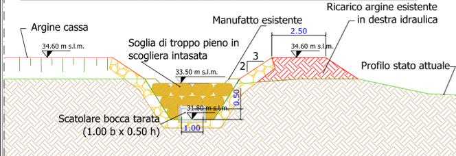
SFIORATORE DI CATTURA - SEZIONE B-B' - scala 1:100 -
