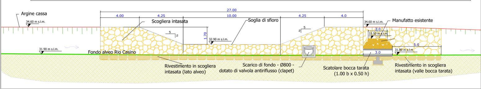
SFIORATORE DI CATTURA E BRIGLIA PER L'OTTIMIZZAZIONE DELLA SOGLIA - PLANIMETRIA DI DETTAGLIO - scala 1:200 -
