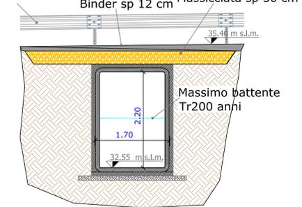
Demolizione attraversamento agricolo esistente e realizzazione nuovo attraversamento (sez. 12.15) Scatolare in c.l.s. 1.70 x 2.20 m (b x H)
