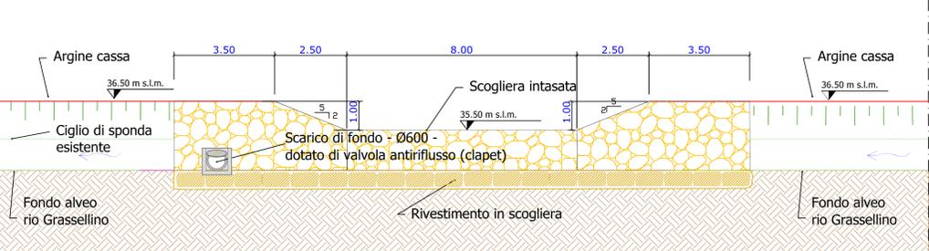
**SFIORATORE DI TROPPO PIENO E SCARICO DI FONDO PLANIMETRIA DI DETTAGLIO - SCALA 1:200 -**
