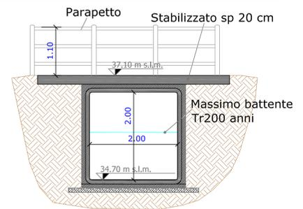
Demolizione attraversamento esistente e realizzazione nuovo attraversamento su s.p. Sanminiatese (sez. 20.5) Scatolare in c.l.s. 1.60 x 1.60 m (b x H)
