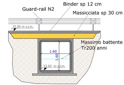
Nuovo attraversamento rampa complanare (sez. 14.5) Scatolare in c.l.s. 1.70 x 2.20 m (b x H)
