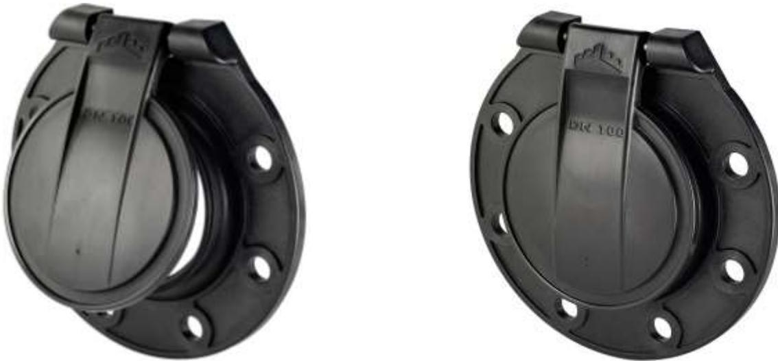
**VOCE DI CAPITOLATO** : Fornitura di valvola antiriflusso fine linea a battente verticale costruita in poliammide , per accoppiamento a parete verticale o a flangia forata PN10 ; tenuta idraulica 1 bar; guarnizione di tenuta in EPDM
