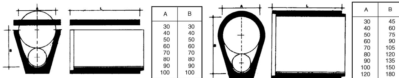
FIG. 21 - Collettori ovoidali. Sezione classica 2r - 3r
