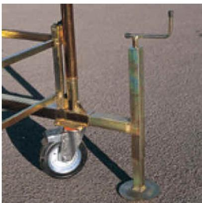
Occorre verificare la solidità e la planarità del piano di appoggio ed eventualmente procedere ad un livellamento mediante l'uso di tavoloni quando il ponte non sia già di per sé predisposto con i montanti regolabili in altezza.
