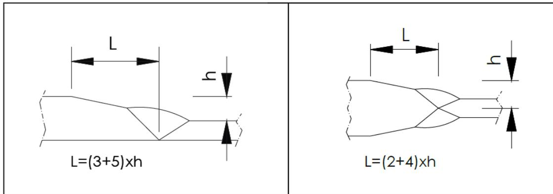
Acciaio Profilati S275 UNI EN 10025-2 - Saldature cl. II
