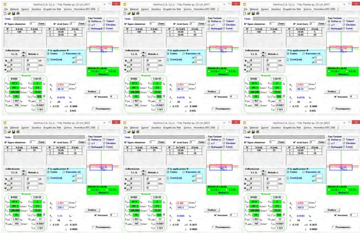
PARETI sp. 25 cm – verifica delle tensioni di esercizio e di fessurazione
