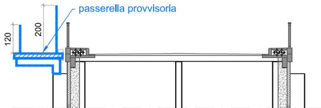
Potranno quindi essere rimosse travi/tiranti, le catene di collegamento dei muri laterali ed il riempimento provvisorio della spalla eseguito per l'installazione della passerella, e si potrà realizzare lo scavo preparatorio all'esecuzione della paratia di micropali.
