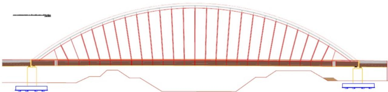
Figura 7: Prospetto tipologico ponte ad arco a via inferiore su Ombrone
