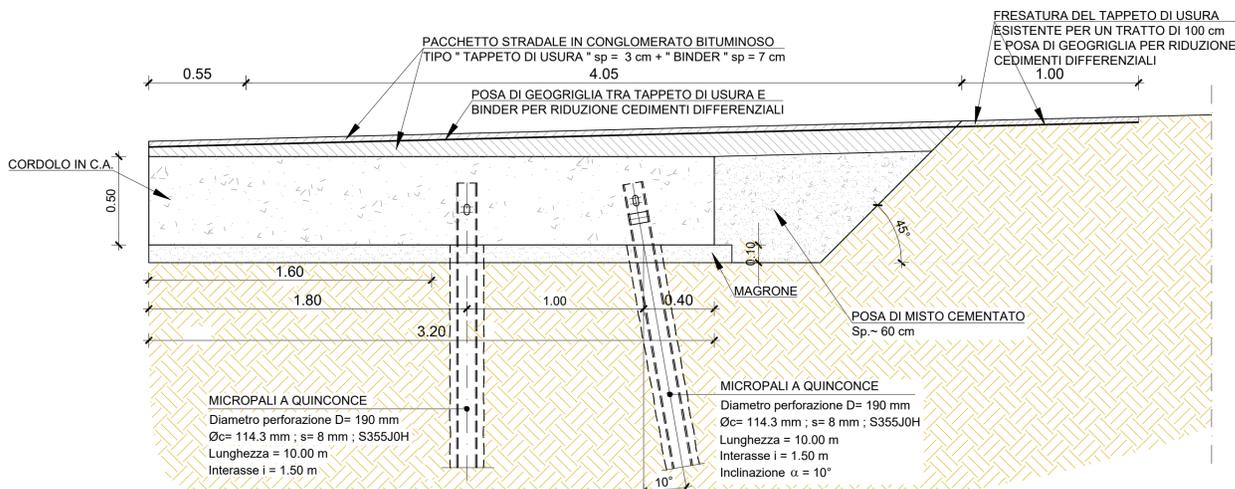
SEZIONE TIPOLOGICA DEL CORDOLO TIPO 3 - IN C.A. SU MURO E SU RILEVATO | SCALA 1:20
