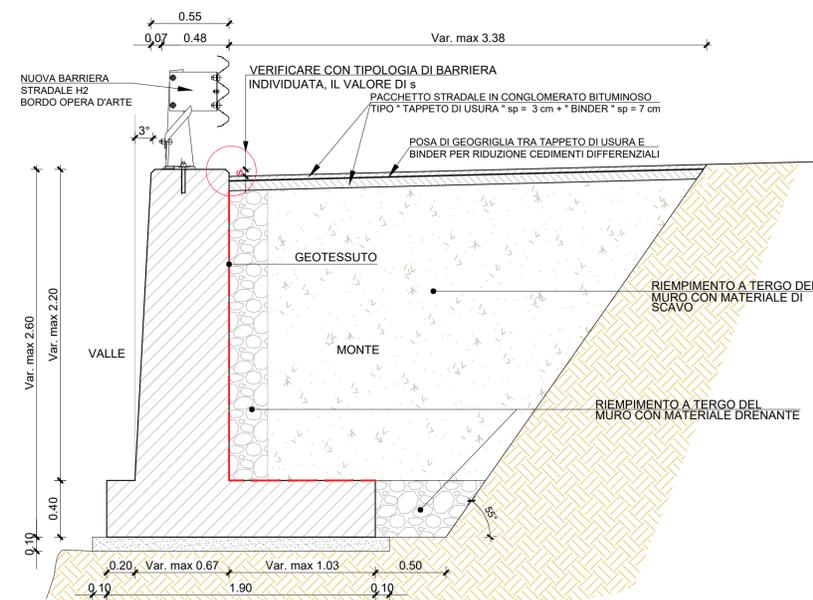
PARTICOLARE SCHEMA PAVIMENTAZIONE DI PROGETTO A TERGO DEL CORDOLO | SCALA 1:10
