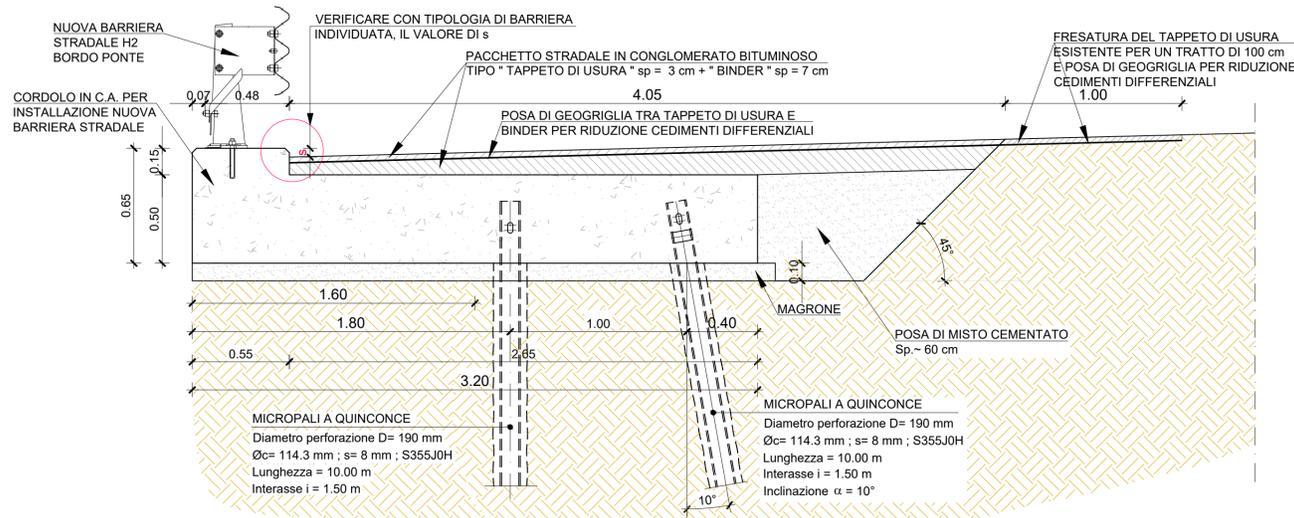
SEZIONE TIPOLOGICA DEL CORDOLO TIPO 2 - IN C.A. SU PALI | SCALA 1:20
